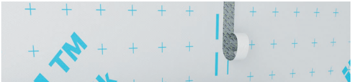
Wird mit einer Überlappung von mind. 100 mm angebracht und mit dem DAFA Dampfsperrenband verklebt. Übergänge, Durchführungen und Anschlüsse müssen stets auf einer stabilen Unterkonstruktion verlaufen.
