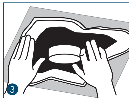
3 Før kraven over røret så tæt på dampspærren som muligt, før aftrækspapiret fjernes.
