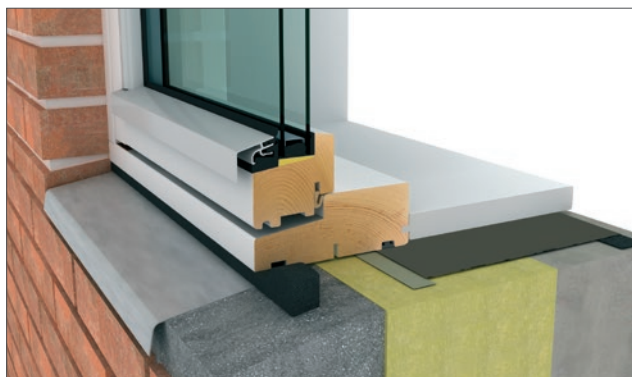
Udvendig fuge udført med illmod 600 fugebånd. Indvendigt lufttæt med DAFA fugefolier.
