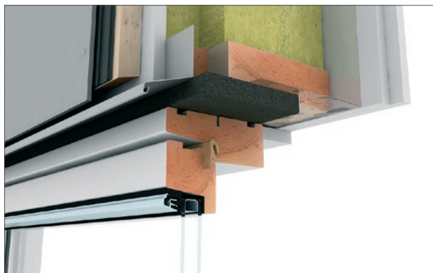
illmod Trio+ til udvendig tætning mod slagregn, mellemisolering og indvendig tætning i ét og samme produkt.
