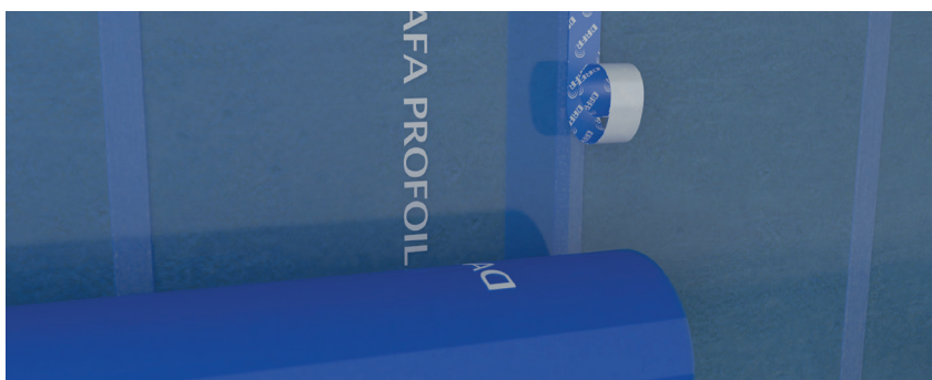
Monteres med overlæg på min. 100 mm og tapes med DAFA dampspærretape. Samlinger, gennemføringer og tilslutninger skal altid udføres med fast underlag.
