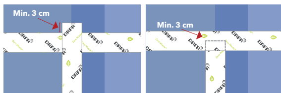
Lös ände (över befintlig) kan fästas med min. 3 cm överlapp.
