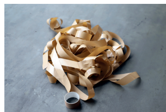
Reduser byggeavfall. Detta bildet visar hvor mye avfall én rull tape (25 m) med liner produserer.
