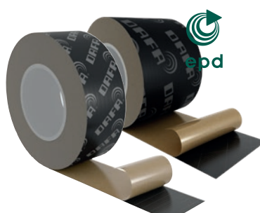
DAFA UV-tejp - är en UV-beständig, ensidig polyeten-tejp som är speciellt lämplig utomhus för tätning och fästning av undertak och vindskydds dukar.
