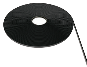
Norton självhäftande PVC-list - används som tätning mellan takplattor, vilket förhindrar att vatten, damm och smuts tränger in.
