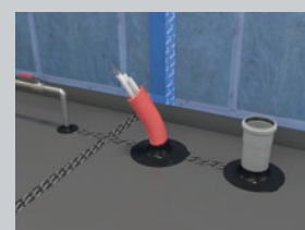
Monteret på radonspærre
