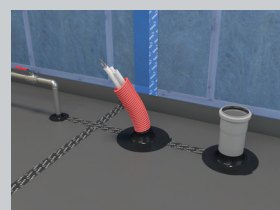
Monteret på radonspærre
