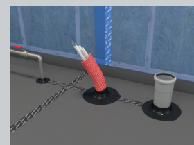
Monteret på radonspærre
