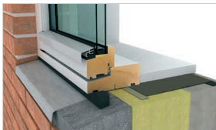
Fog utomhus, utförd med fogbandet illmod 600. Invändig lufttätning med DAFA fogfolie.
