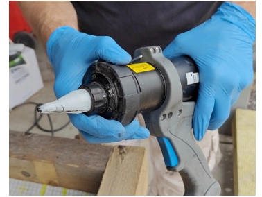
Skrue hele toppen med de 2 fugespids på. Skal strammes godt og grundigt.
