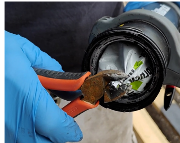
Indsæt posen med 600 ml. DAFA SprayBarrier ned i cylinderrøret og klip enden af posen med en knibtang lige under metalklappen.
