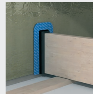
DAFA spærfodskrave - anvendes som tætning omkring spærfod og skunkstolpe, hvor dampspærren gennembrydes. Leveres i én størrelse, som til-dannes nemt på stedet.
