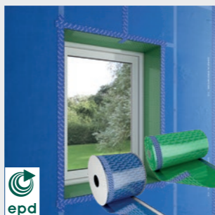
DAFA PE lysningsfolie - anvendes til lukning i ét stykke hele vejen rundt i vindues- og dørløsningen. Lysningsfolien leveres i flere standardbredder på rulle - forberedt med tape til montering på bagsiden af karmstykket.
