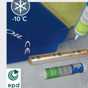
DAFA folieklæb - anvendes til tæt limning af dampspærrefolier på sugende, porøse underlag, som f.eks. på puds, gasbeton, beton eller ubehandlet træ. Montage ned til -10 °C.
