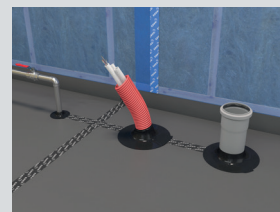
Monteret på radonspærre
