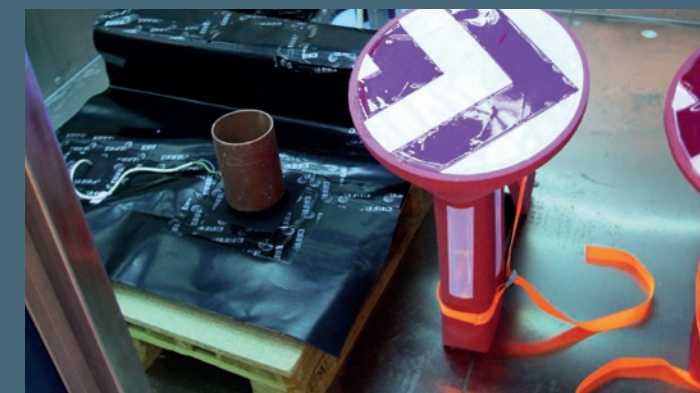
Produktene utsettes for kraftig klimapåvirkning fra varme, kulde, UV-lys og fuktighet.
