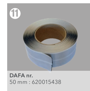
DAFA Multi Sealing™ – används för tätning på platser där konstruktionsdelar bryter igenom radonspärren. Ett mycket flexibelt material som kan användas till ojämna och runda kanter.
